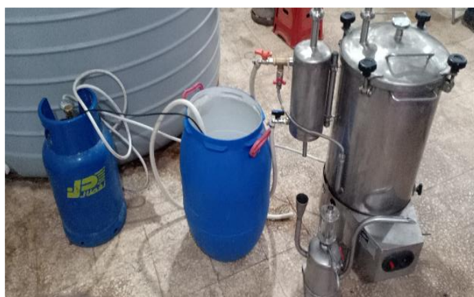
Figure 18 Photo de dispositif d'hydrodistillation (Originale, 2022)
